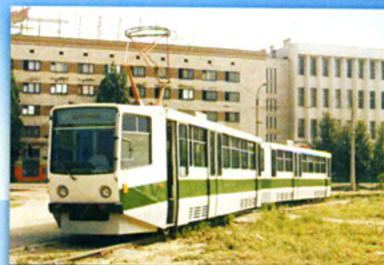
Трамвайный вагон модели 71-611 для скоростных линий с двухсторонним расположением дверей 1993 г.
