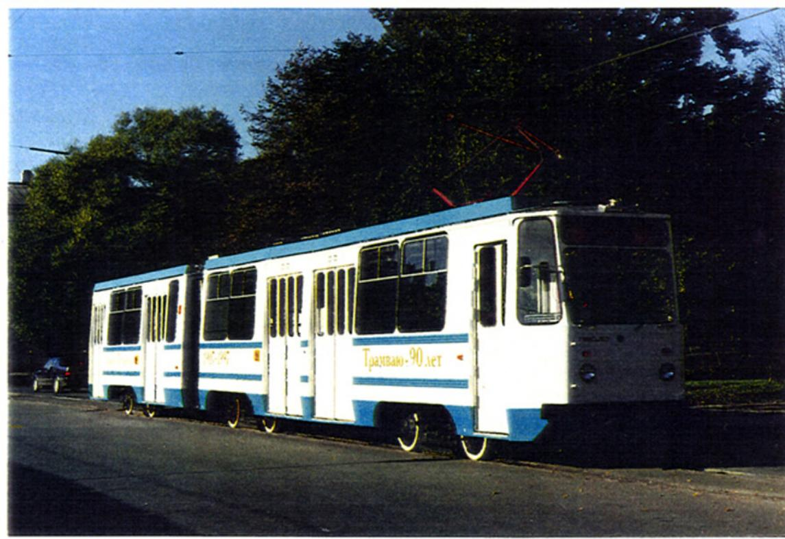
В зоне сочленения опорной тележки нет, поэтому пол выровнен по всей длине вагона. Соединение резиновое по типу автобусов "Икарус". Теперь передняя секция вагона имеет длину 13 метров и под ней находятся две моторные тележки.
