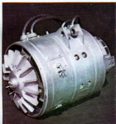
Тяговый двигатель с сановентиляцией
